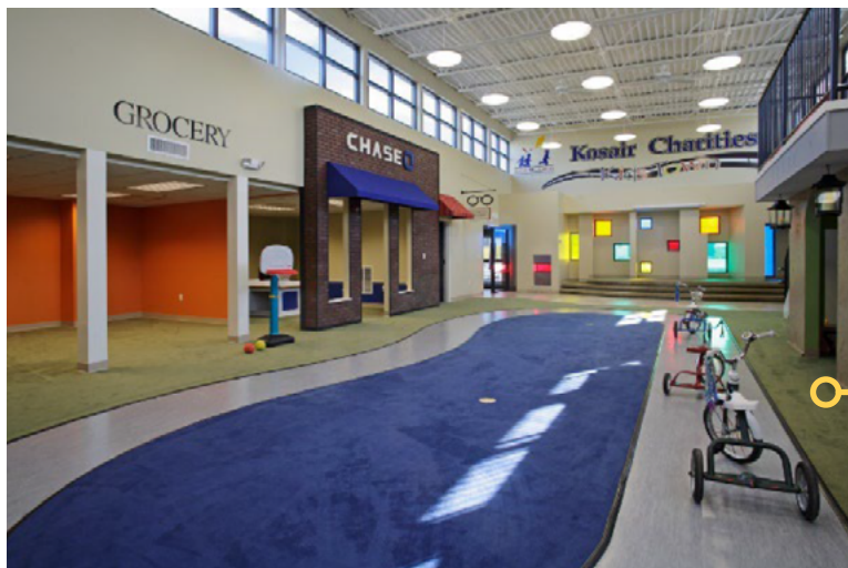
25 pav. Skirtingos grindų medžiagos padeda orientuotis neregiams, kontrastingos spalvos – silpnaregiams.
